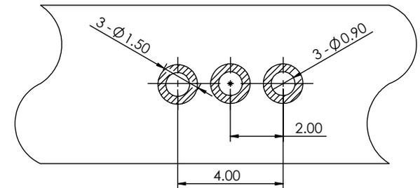
RECOMMENDED PCB LAYOUT (T:1.2mm)
