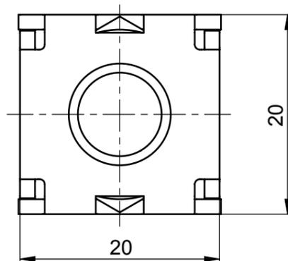
**Maximales Drehmoment bei M10: 31Nm**
