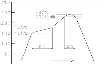
FIG - 2 RECOMMENDED REFLOW PROFILE TEMPERATURE
